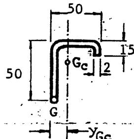
$$\begin{aligned} (15 \cdot 2) \cdot 49 &= 1470 \text{ mm}^3 \\ (46 \cdot 2) \cdot 25 &= 2300 \text{ mm}^3 \\ (50 \cdot 2) \cdot 1 &= 100 \text{ mm}^3 \\ &\hline 3870 \text{ mm}^3 \end{aligned}$$
