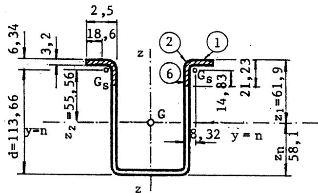
b) Posición del centro de gravedad del soporte equivalente
