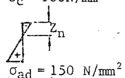
$$\sigma_c = \frac{28,02 \text{ mm}}{80 \text{ mm} - 28,02 \text{ mm}} \cdot 150 \text{ N/mm}^2$$
