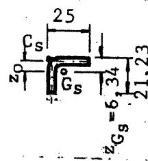
$$z_0 = z_{G_s} - \frac{t}{2} = 6,34 \text{ mm} - \frac{3,2 \text{ mm}}{2} = 4,74 \text{ mm}$$
