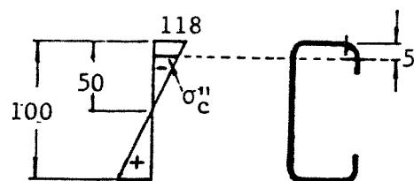
$$\sigma''_c = \frac{50 \text{ mm} - 5 \text{ mm}}{50 \text{ mm}} \cdot 118 \text{ N/mm}^2$$
