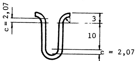
$$2 \cdot 1,5 \text{ mm} (10 \text{ mm})^3 \cdot \frac{1}{12} = 250 \text{ mm}^4$$
